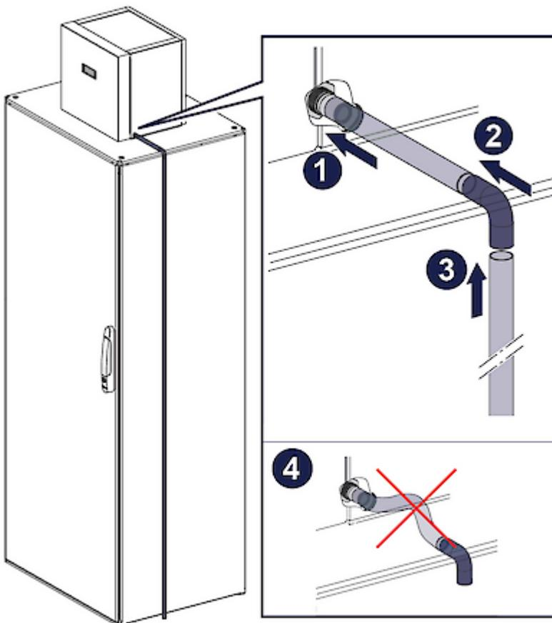
1. Schneiden Sie ein kurzes Teil vom Kondensatablauf - Schlauch ab, und verbinden Sie dieses mit dem Ablaufstutzen seitlich am Kühlgerät.
