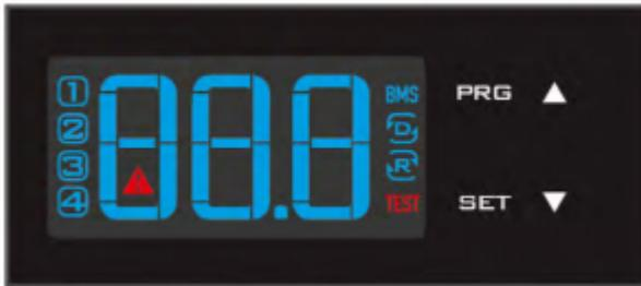
Das Display zeigt Temperaturen im Bereich von -50°C bis 150°C (-58°F to 302°F) an. Die Temperatur wird in Zehnerschritten von -19.9°C bis 99.9°C (-3.8°F bis 211.8°F) angezeigt. Während des Programmierens werden sowohl die Kurzzeichen als auch die jeweiligen Werte angezeigt. Das Display zeigt auch die jeweiligen Symbole entsprechend den Ereignissen an.
