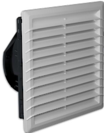
Seifert Filterlüfter werden zur optimalen Belüftung von Schaltschränken eingesetzt. Die Zuführung gefilterter kälterer Außenluft sowie die Abführung warmer Innenluft garantieren eine optimale Temperatur im Schaltschrank. Es werden 2 verschiedene Luftstromrichtungen angeboten. Blasend - in den Schaltschrank hinein blasend (Standard) und saugend - aus dem Schaltschrank heraus saugend (auf Anfrage). Der Luftstrom variiert je nach Spannung und Luftrichtung zwischen 244 und 273 m<sup>3</sup>/h.
